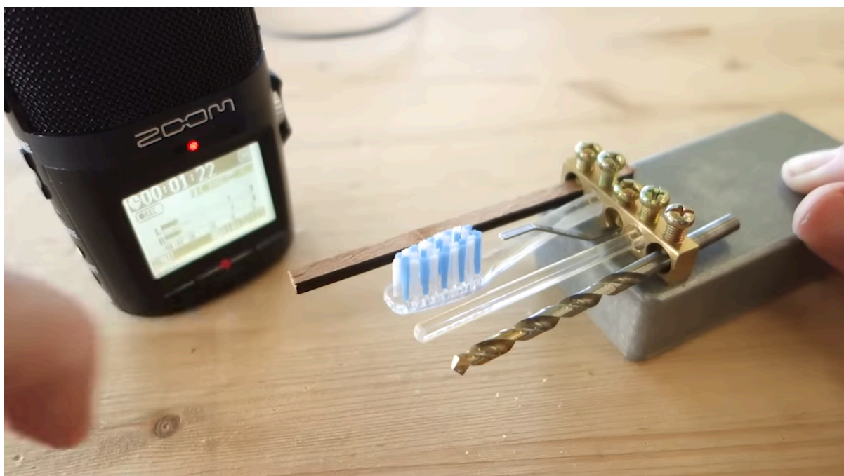
Figura 5 - Noisebox em caixa de alumínio com objetos fixados em barra de aterramento.
