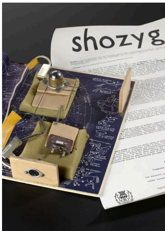
Figura 18 – Shozyg construído entre as capas de uma enciclopédia
