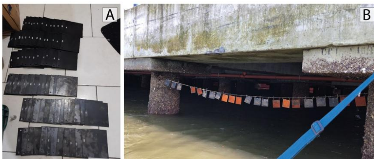
Figura 1 A) Acima estão as placas de PVC e abaixo as placas de metal. B) Ponto amostral no Píer TCP e a linha de placas do supralitoral exposta na primeira instalação. As linhas de médio e infralitoral estão submersas. As imagens mostram placas de PVC e de ferro, essas últimas não utilizadas no presente estudo.
