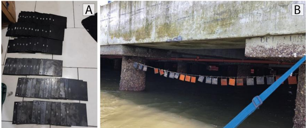
Figura 75A) Acima estão as placas de PVC e abaixo as placas de metal. B) Ponto amostral no Píer TCP e a linha de placas do supralitoral exposta na primeira instalação. As linhas de médio e infralitoral estão submersas.
