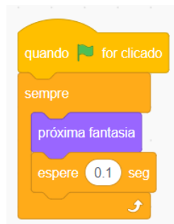
Figura 4.19 – Sequência de blocos que controlam a alternância de fantasias na animação no Scratch
