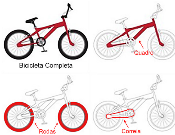
Figura 2.5 – Partes da bicicleta exemplificando a decomposição
