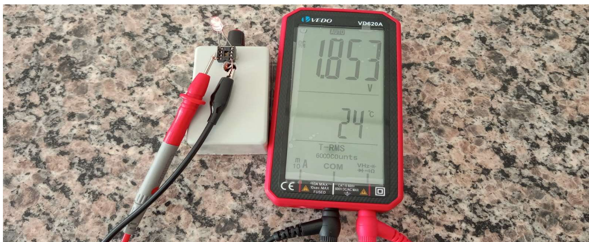
Figura 16: Foto da montagem do experimento para calcular a constante de Planck.
