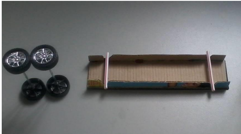
Figura 7: Colagem de canudinhos no chassi de papelão para a sustentação dos eixos
