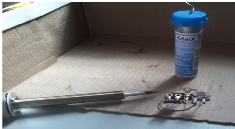
Figura 12: Soldando os componentes na ponte de terminais
