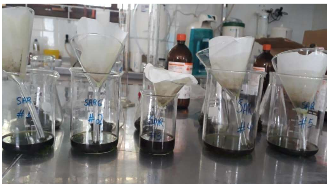
Figura 6: Procedimento de filtração do extrato metanólico das macroalgas marinhas. Realizado no mês de setembro de 2022.
